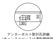
アンカーボルト取付孔詳細 (チャンネルベースは溝形鋼使用)
