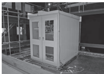
耐震試験 3軸同時加振 神戸波 (0.8G)
