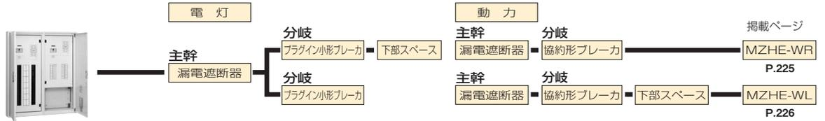
電灯動力混合分電盤
