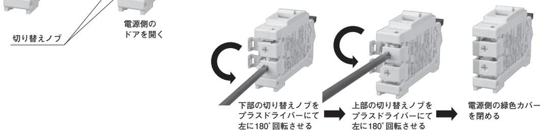
2P2E 200V (100V・RT 相切り替え式) を取り揃え分岐回路電圧、相の変更も容易です。
