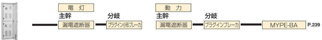
電灯動力混合分電盤
