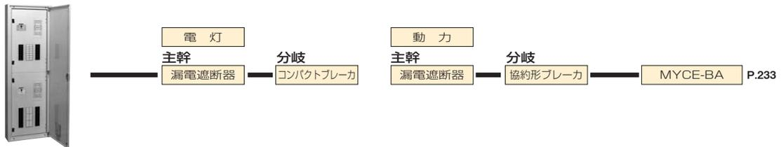
電灯動力混合分電盤
