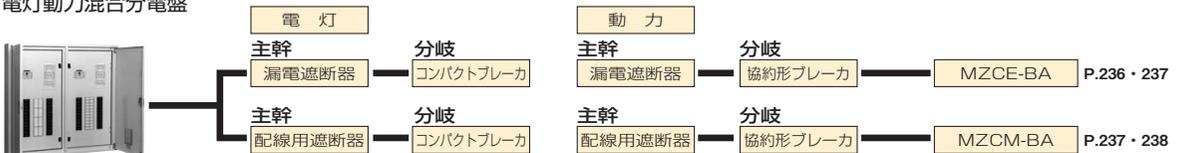
電灯動力混合分電盤
