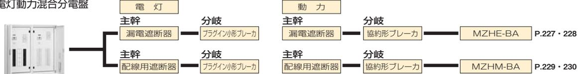
電灯動力混合分電盤
