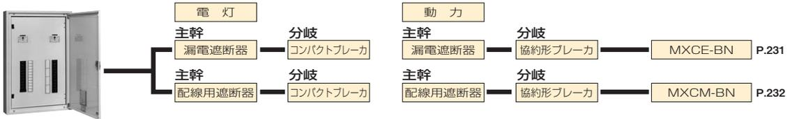
電灯動力混合分電盤
