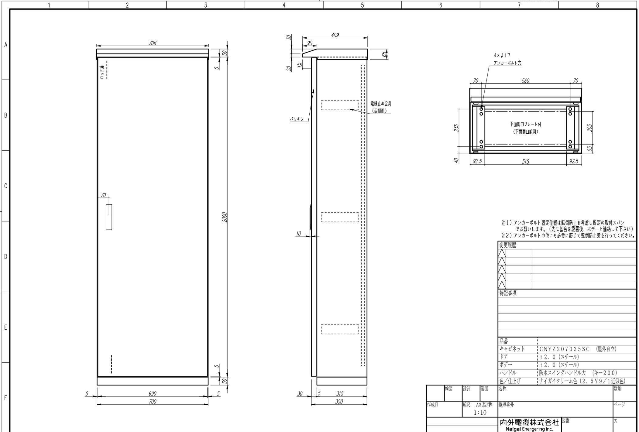
注1) アンカーボルト 固定位置は転倒防止を考慮し所定の取付スパン
